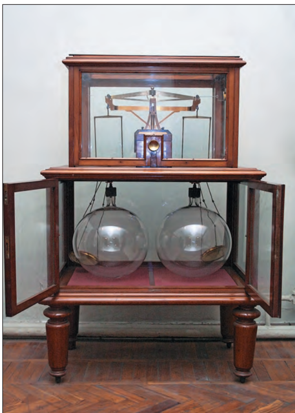
Двухъярусные весы для взвешивания газов конструкции Менделеева.
